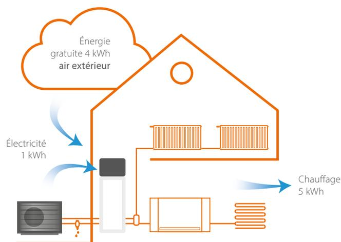
Explication : pour 1 kWh d'électricité consommée, la pompe à chaleur va restituer jusqu'à 5 kWh de chaleur selon les conditions climatiques et le type de logement.
